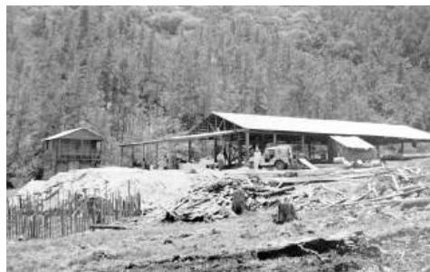
Vista general del aserradero de Santiago (Chago) Infante Pierna, el cual fue movilizado entre la loma Mono Mojado, Yerba Buena y La Cieneguita. Estos aserraderos corresponden a industrias de primera transformación, en la que a los troncos de los árboles talados se les hacen cortes longitudinales y transversales con sierras circulares o de sinfín que dan como resultado piezas cuadradas, para luego cortarlas y sacar tablas o tablonés.
