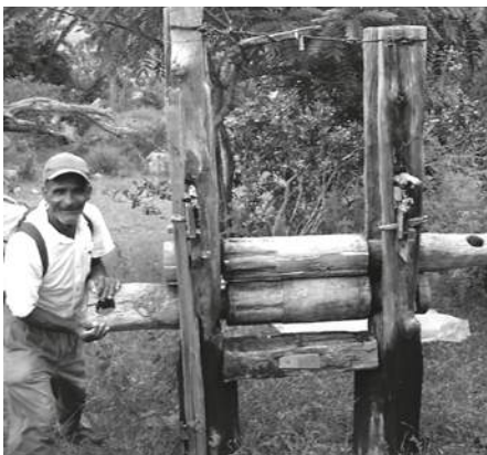
En el pasado la siembra de caña de azúcar estuvo muy extendida en Constanza, y a mediados de la década de los años treinta del siglo XX funcionaban trapiches con tecnología similar a la usada en el siglo XVI: dos mazos de madera movidos por fuerza muscular. Aún uno de ellos permanece en uso en Las Cuevas; Santos Ferreras Victoriano aparece mostrándolo. La mayoría de los trapiches del valle eran fabricados por Damián García Rosado y por Francisco (Pancho) Suriel Campero. Algunos propietarios fueron Ramón María (Maliú) Queliz Victoriano, Cristóbal Soriano Espinosa, Elias Reyes, Pedro Ignacio, Manuelico Abreu, Zacarías Pinales Victoriano, Ruperto Rosado y Antonio Abud Isaac. Con el guarapo fabricaban raspaduras para comer, melao para endulzar y melaza para las vacas. 1998.
